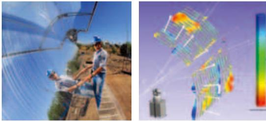
激光雷达在绿色能源市场的应用越来越广，因为它能够测量诸如太阳能面板和风力发电机叶片等大尺寸和易碎的结构件
