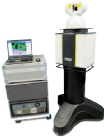
激光雷达是生产力的倍增器。激光雷达支持非接触式检测和真正的单人操作，同时也支持离线编程，实现全自动化无人操作。激光雷达采用尼康专利技术，能以高数据速率直接测量表面和特征。因此，激光雷达将用户从拍摄测量目标、球形反光镜（SMRs）或手持式测头的繁琐使用中解放出来，大幅降低了检测时间和成本。
